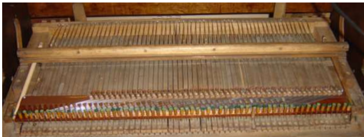
Fig. 4. – Vue d'ensemble de la mécanique. Au premier plan, première rangée de pilotes de touches. Au deuxième plan, le mécanisme d'octave aiguë agissant sur la deuxième rangée de pilotes [4].
