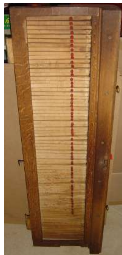
Fig. 2. – Vue inférieure du clavier avec la rangée de pilotes du mécanisme de « mains doublées » [4].
